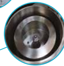
Standardmäßige ungelochte Dekantertrommel Ø 200 mm (Nutzvolumen 1,2 Liter) oder Ø 300 mm (nutzbares Volumen 5,5 Liter) oder eine Trommel mit zwei Öffnungspaa- ren im oberen Teil, die mit Schraubverschlüssen versehen sind, um unterschiedliche Prozessmen- gen einzustellen.
